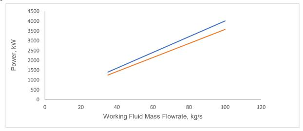
Figure 9. Effect of mass flowrate on power production using CO<sub>2</sub> as geofluid at 100 °C Slika 9. Uticaj masenog protoka na proizvodnju energije korišćenjem CO<sub>2</sub> kao geofluida na 100 °C
