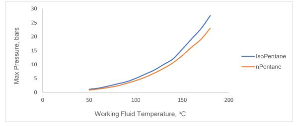
Figure 5. Maximum working fluid outlet pressure for water geofluid Slika 5. Maksimalni izlazni pritisak radne tečnosti za vodeni geofluid
