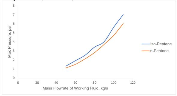
Figure 8. Maximum Working Fluid Outlet Pressure for Water geofluid Slika 8. Maksimalni izlazni pritisak radne tečnosti za vodeni geofluid
