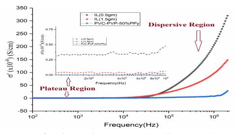
Figure 6. Variation in  $\sigma'$  with frequency for ternary polymer blend film with and without choline acetate Slika 6. Varijacija u  $\sigma'$  sa frekvencijom za film mešavine ternarnog polimera sa i bez holin acetate
